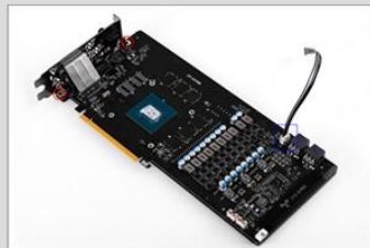
11. 安装图中标蓝位置数据延长线及 标红位置螺丝
