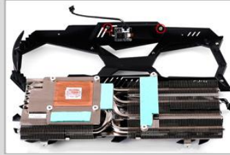
4. 拆除图中标红位置螺丝
