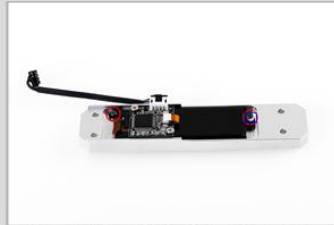
6. 将第三步处留用螺丝安装在图中标红位置， 标蓝处需在螺丝与显示屏之间放两个白色薄垫片 (60/70/1070Ti Vulcan X如图所示,1070Ti Vulcan X Top/80 需将两个白色薄垫片放于显示屏与面板之间)
