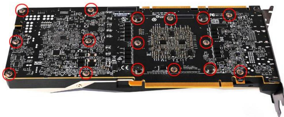
2. 拆除图中标红位置铜柱及螺丝
