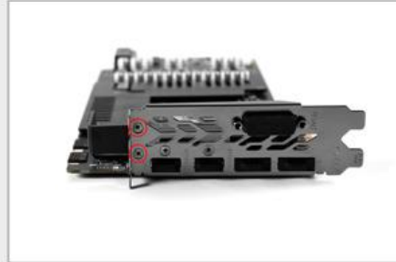
拿下散热器，拆除图中标红位置螺丝
