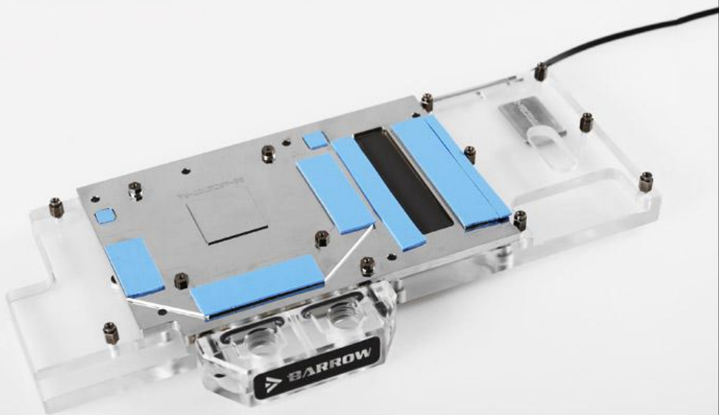
4.在相应位置贴好相应规格导热硅脂条，注意剪切尺寸
