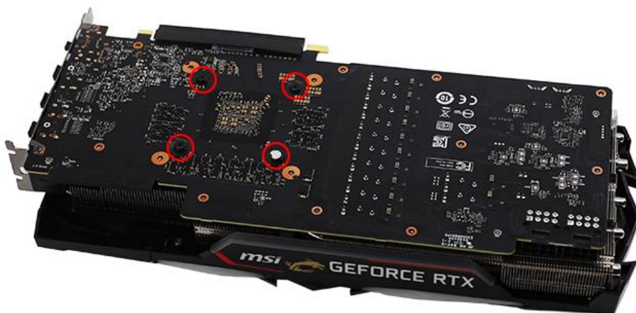
2. 拆除图中标红位置螺丝
