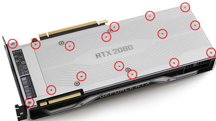
1. 拆除图中标红位置螺丝
