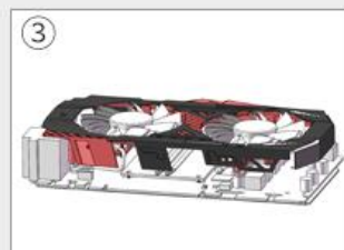
拆除风扇的电源线并分离原装散热器
