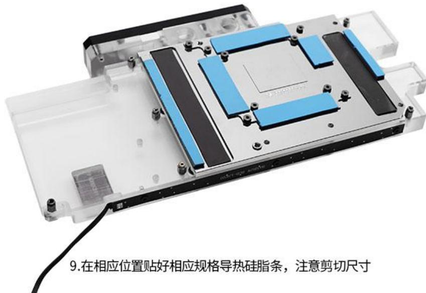
9.在相应位置贴好相应规格导热硅脂条，注意剪切尺寸
