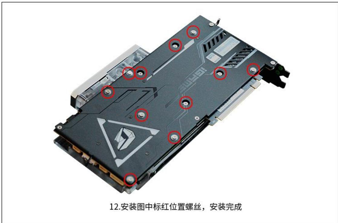
12. 安装图中标红位置螺丝，安装完成
