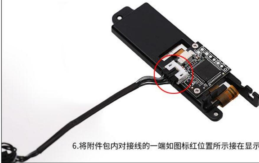
6.将附件包内对接线的一端如图标红位置所示接在显示屏上
