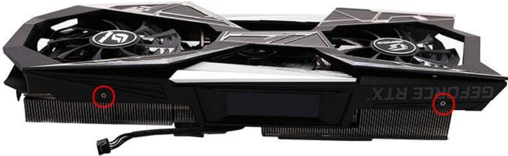
3.拆除图中标红位置及对面4颗螺丝，取下风扇，放好两颗螺丝备用
