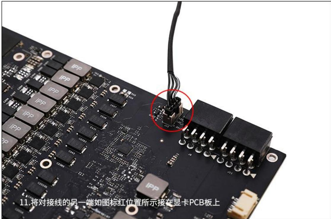
11. 将对接线的另一端如图标红位置所示接在显卡PCB板上
