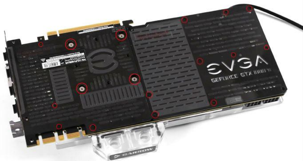
安装图中标红位置螺丝注意力度
