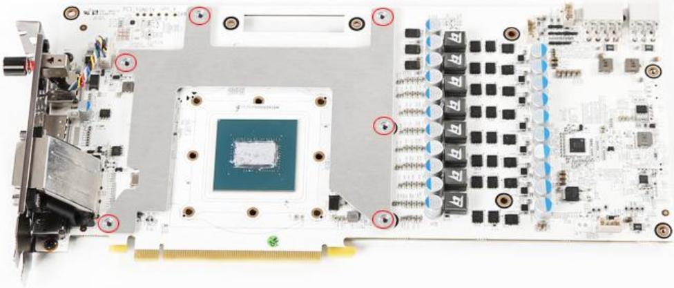
拆除图中标出螺丝并取下原装散热板
