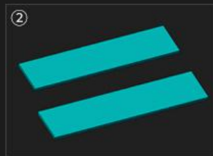
将导热胶垫切为合适的尺寸
