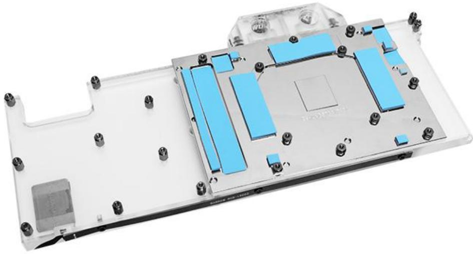
5.在相应位置贴好相应规格导热硅脂条，注意剪切尺寸
