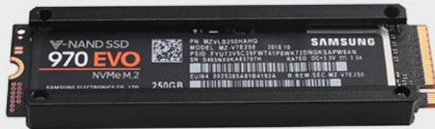
3.将硬盘缓缓送入散热件槽中（注意金手指及固定缺口需留在槽外）
